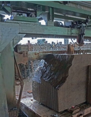
Gattersäge mit diamantbestücktem Sägeblatt.
